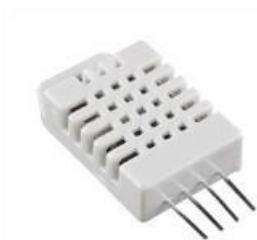
2.3-сурет – Температура және ылғалдылық датчигі (RHT-03)
