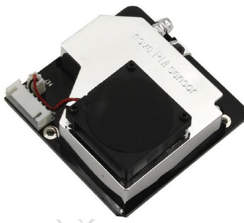
2.5-сурет – Лазерлік шаң датчигі (SDS011)
